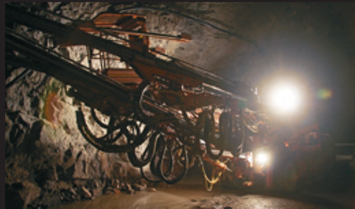
Tamrockin valmistama porausjumbo on hurja laite, jonka kolme poraa tekevät reikää noin kuuden metrin syvyyteen. Poranterien halkaisija on yli viisi senttiä.
